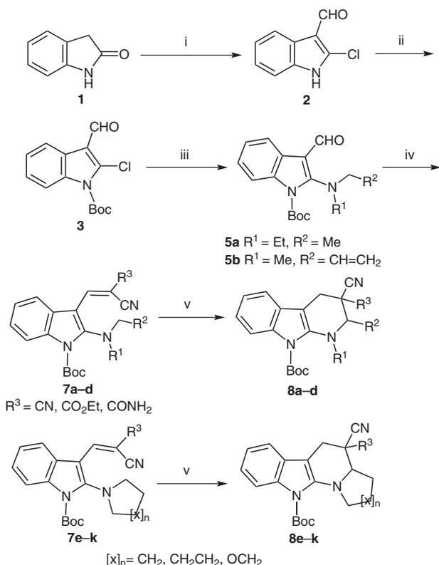
**Scheme 1** Reaction conditions: (i) DMF,  $\text{POCl}_3$ ; (ii)  $\text{Boc}_2\text{O}$ ; (iii)  $\text{Et}_2\text{NH}$  (**4a**) or  $\text{HNMe}(\text{CH}_2\text{CH}=\text{CH}_2)$  (**4b**) or pyrrolidine (**4c**) or piperidine (**4d**) or morpholine (**4e**); (iv) piperidine,  $\text{CH}_2(\text{CN})_2$  (**6a**) or  $\text{CNCH}_2\text{CO}_2\text{Et}$  (**6b**) or  $\text{CNCH}_2\text{CONH}_2$  (**6c**); (v) DMF,  $90^\circ\text{C}$ .
